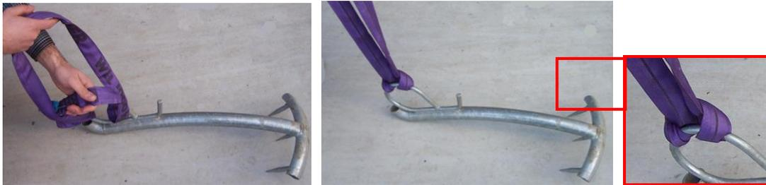
Befestige nachher das zweite Hebeband um die Haupttröhre des Baumladehakens, wie hierunter bezeichnet.
