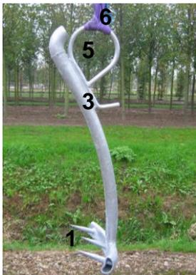
Der Baumladehaken Kompakt ist ein Werkzeug für das versetzen von einem Baum mit Ballen welcher mit einem Weidenkorb versehen ist. Die Ballenpinne (1) stechen in den Ballen des Baums. Ein Hebeband (2) das um die Hauptröhre (3) des Rahmens geht herum den Baumstamm und wird hinter den Hakenpflock (4) angehakt, so dass der Baum fest hängt. Der Baumladehaken hängt mittels eines anderes Hebebandes (6) welches an den Handgriff (5) befestigt ist an einem Kran.
